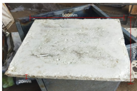
Figura 4. Prototipo desmoldado para verificación física Nota. Registro visual del panel tras el proceso de desmolde, donde se verifican las dimensiones estándar de 500 × 500 × 20 mm. Esta uniformidad geométrica es indispensable para garantizar que el cálculo de transferencia de calor sea preciso y comparable entre las distintas muestras del estudio. Fuente: Elaboración propia (2026).
