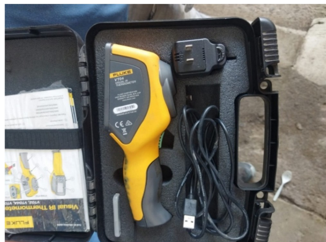
Figura 5. Termómetro infrarrojo visual
