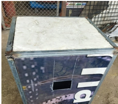
Figura 3. Panel aislante en estado sólido tras el proceso de encapsulado Nota. Estructura final del prototipo tras el fraguado del poliuretano. El material alcanzó su rigidez definitiva, garantizando la cohesión con las fibras y un espesor uniforme de 50 mm (dimensión del molde). Fuente: Elaboración propia (2026).
