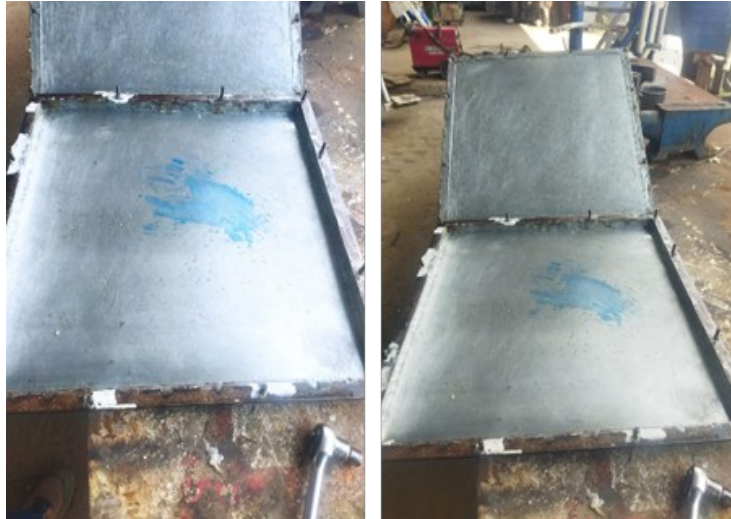
Figura 2. Molde metálico para la elaboración de los paneles con fibras naturales
